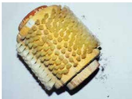
Щетка банника для прочистки орудийного ствола, одно из изделий, изготавливаемых на щеточной фабрике
