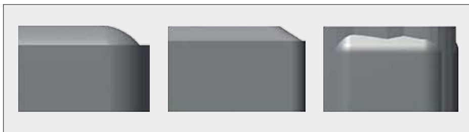
Вариации фасок лицевой поверхности тротуарной плитки
